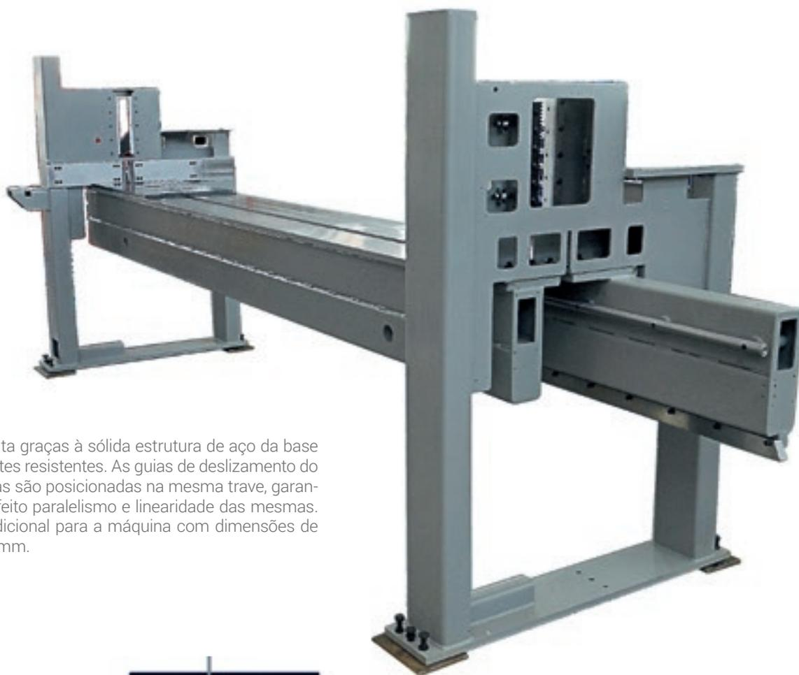
Estabilidade perfeita graças à sólida estrutura de aço da base apoiada por suportes resistentes. As guias de deslizamento do carro porta-lâminas são posicionadas na mesma trave, garantindo assim o perfeito paralelismo e linearidade das mesmas. Suporte central adicional para a máquina com dimensões de 3800 mm x 3800 mm.
