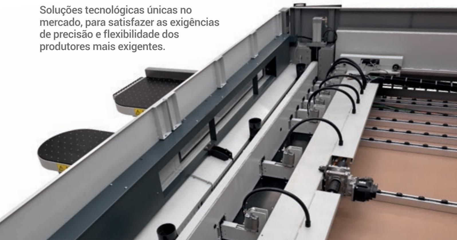
A prensa tem uma estrutura com elemento único que garante uma pressão homogênea e controlada sobre o pacote de painéis a cortar. A abertura é otimizada automaticamente de acordo com a espessura do pacote de painéis para obter a melhor qualidade de corte e reduzir o tempo de ciclo.
